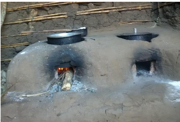
De nieuwe Lorena-oven: er is maar 1 stuk brandhout nodig en er kan met meerdere pannen tegelijk koken
